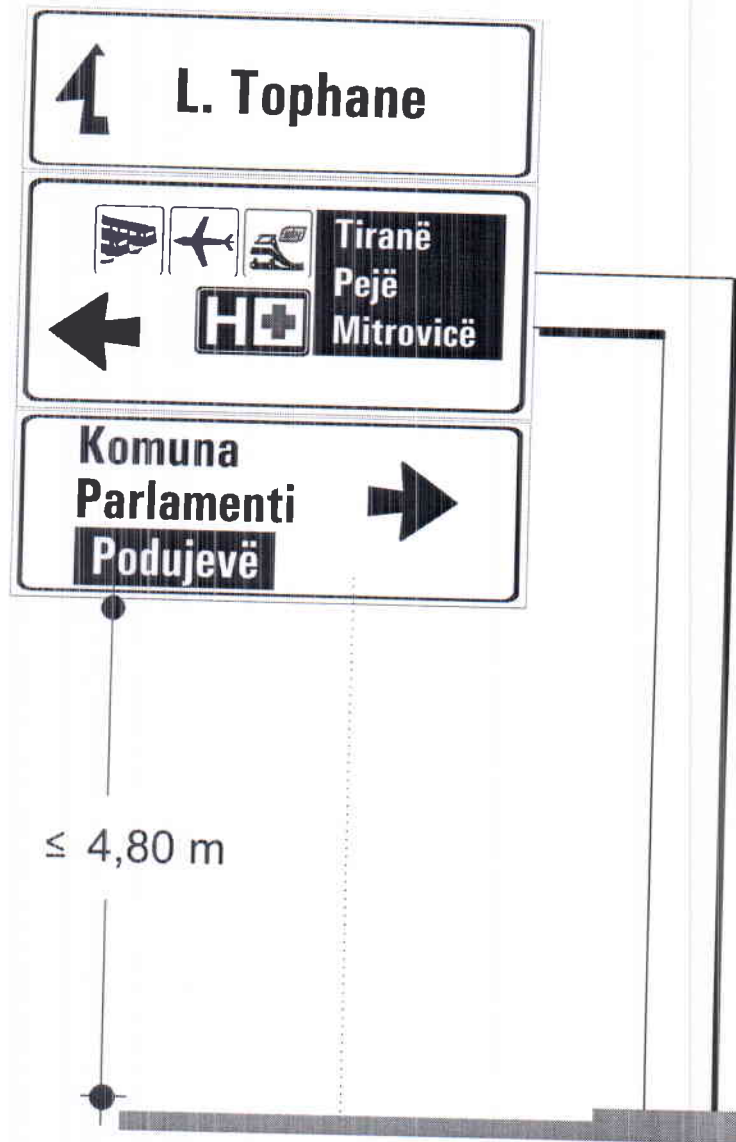
Figura 27. Modelet e konstruksionit mbajtës të tabelave udhëtrëguese të lajmërimit në gjysmëportal
